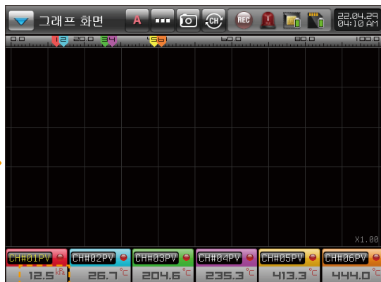
[그림 13-14] 그래프 화면이 kPa 설정인 경우
