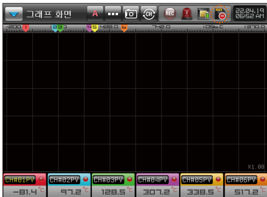
[그림 6-3] SD 카드를 미삽입시 저장이 안되는 화면
