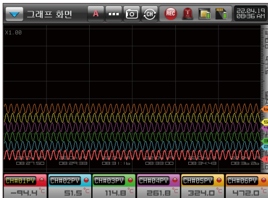
[그림 4-12] PV 그래프(가로) 저장시 운전 화면
