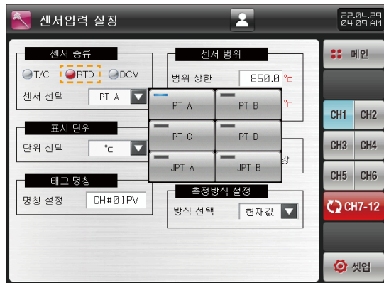
[그림 13-6] RTD의 센서 종류를 선택하는 화면
