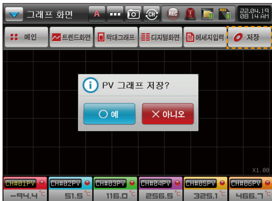
[그림 4-9] PV 그래프 저장 화면
