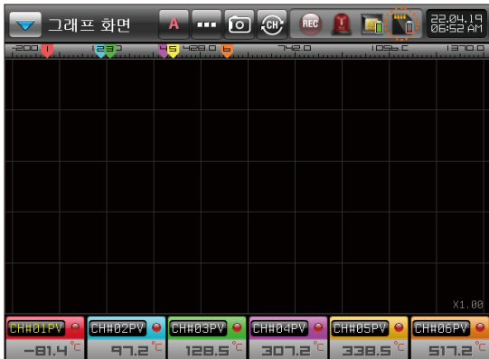
[그림 6-4] SD 카드에 메모리가 꽉 차서 저장이 안되는 화면
