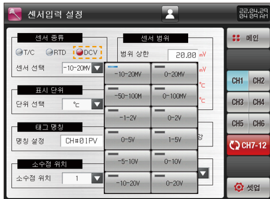
[그림 13-8] DCV의 센서 종류를 선택하는 화면
