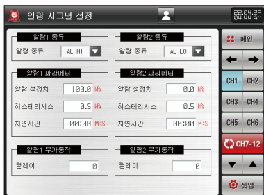
[그림 14-5] PV 상한/하한 설정 화면
