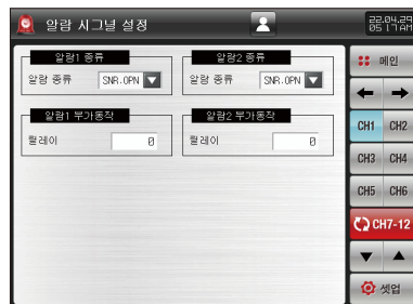
[그림 14-9] 센서 단선 설정 화면
