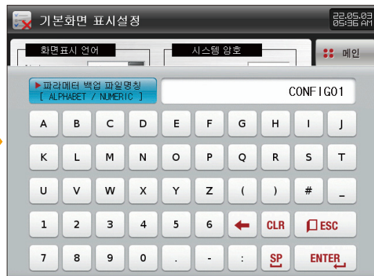
[그림 20-7] SD 카드로 전송할 파일 명칭 설정 화면
