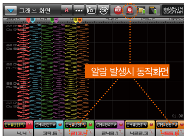
[그림 14-10] 세로축 알람 발생 운전화면
