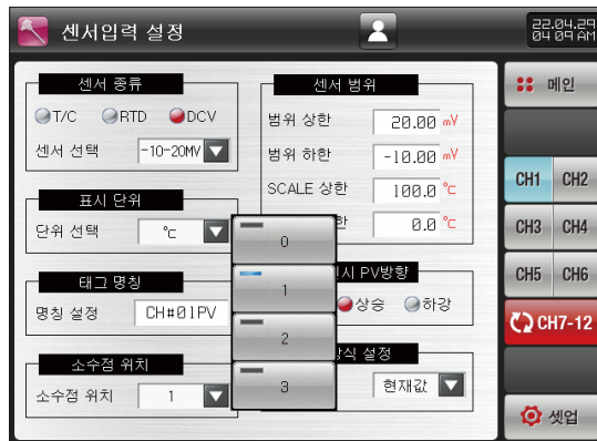
[그림 13-10] DCV 센서의 소수점 위치 설정 화면
