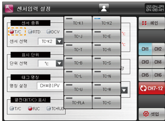
[그림 13-4] T/C의 센서 종류를 선택하는 화면
