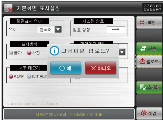
[그림 20-5] SD 카드에 저장된 파일을 내부 메모리로 업로드
